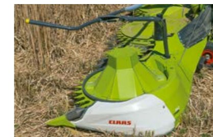
Der große Lagermaisskegel optimiert den Gutfluss und verhindert den Verbleib von Erntegut auf der Transportscheibe.
