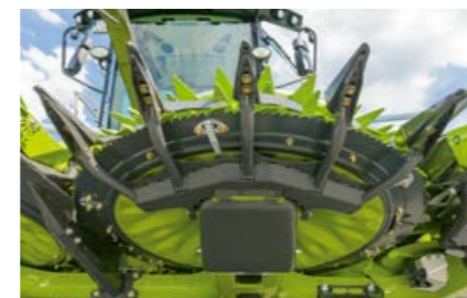
Robuste Einweiserfinger und Ausräumer unter der Messerscheibe für saubere Arbeitsweise.
