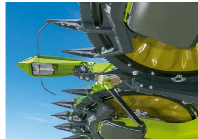
AUTO CONTOUR Mittentaster, erhältlich für ORBIS 900.
