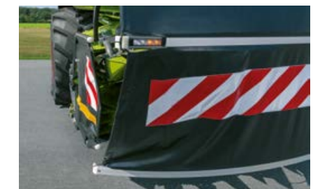
Seiten- und Frontschutz sind mit Warnaufklebern gut sichtbar. Die LED-Beleuchtung ist voll integriert.
