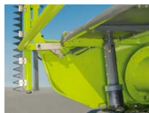
Einstellbare Niederhalter, optional auch hydraulisch.
