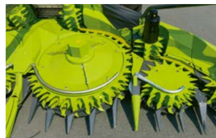
Sicherer Pflanzentransport in den Gutflusskanälen.
