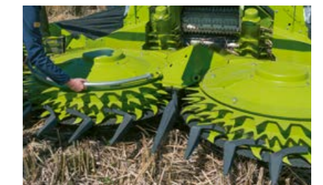
Demontage der Kolbenfallen erhöht die Gutflusstauglichkeit.
