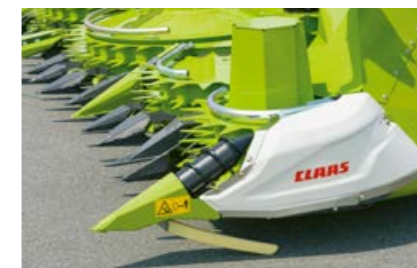
Lagermaisspitze hydraulisch angetrieben.
