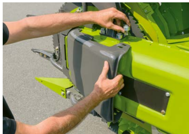
Gleitkufen mit zweistufiger Höheneinstellung.
